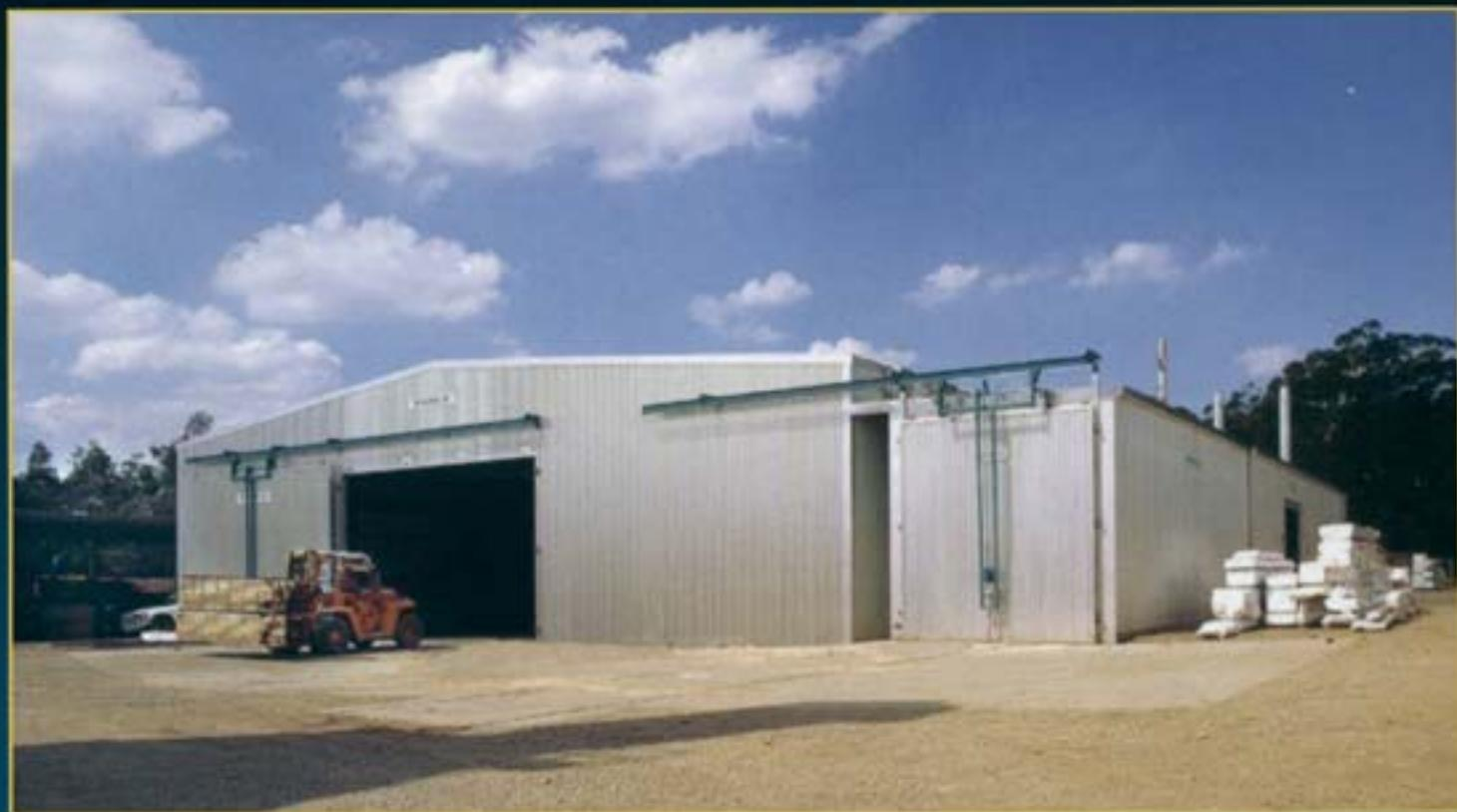
Pre-secadores para grandes volúmenes de madera, con zonas diferenciadas de regulación y control, construidos totalmente en aluminio.
