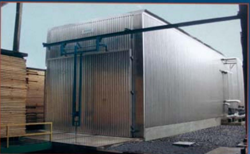
Système de séchage accéléré avec des capacités de 30 à 300 m<sup>3</sup> avec simple, double ou multiple langées de bois avec porte sur un ou deux côtés du séchoir.
