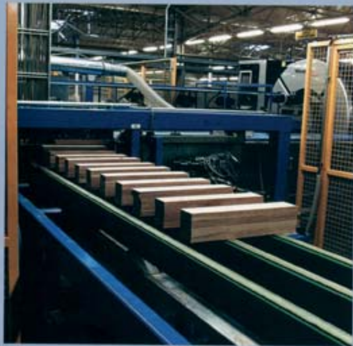
Sistemas de clasificado y transporte para tablillas para parquet.
